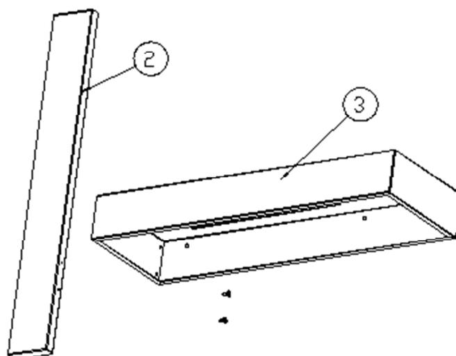
2. Assemblare il vetro 1 alla struttura 3 utilizzando 2 bulloni M5 e le rondelle morbide.
