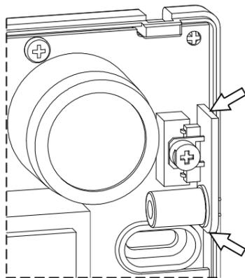
6. Prendere il nuovo modulino sensore e inserirlo nell'apposito connettore, facendo attenzione di far coincidere il connettore del modulino con quello del rivelatore.
