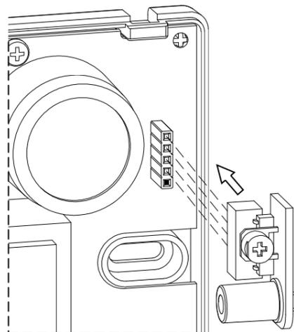
7. Inserire la calotta nell'apposita sede e avvitare la relativa vite.
