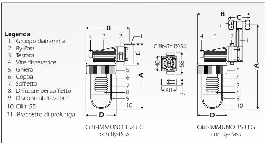
**Fig. 1 - Esempi di installazione Cillit-IMMUNO 152-153 By-Pass FG sull'acqua di alimento a caldaie murali**
