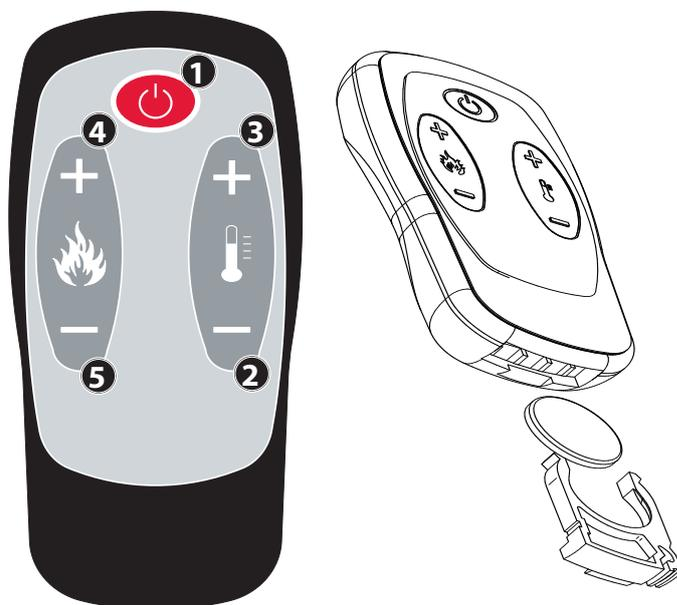
Per il funzionamento è necessaria n° 1 Batterie tampone a litio CR2025 da 3V
