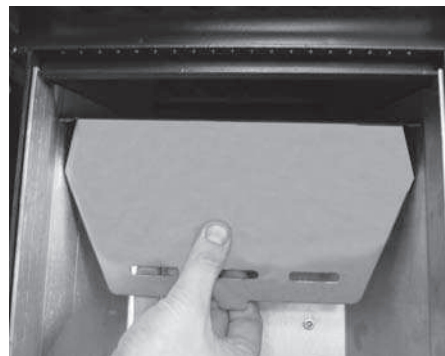
Fig. 16: rotazione del battifiamma
